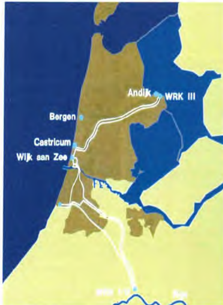
De waterwinning in de duinen van PWN is nauw verbonden met de WRK, die zoetwater vanuit de Rijn en het IJsselmeer naar de infiltratie- en zuiveringsinstallaties in de duinen brengt.
