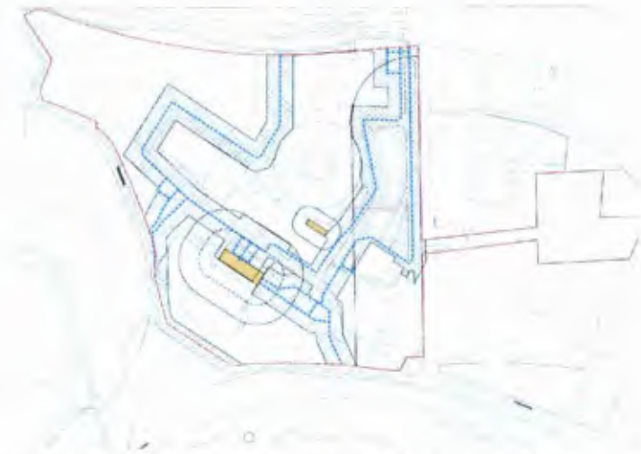
In het blauw het bestaande leidingennetwerk op het terrein, met daaromheen een buffer van vrij te houden ruimte. Ook aangegeven zijn de aanjager en de noodstroomvoorziening.
