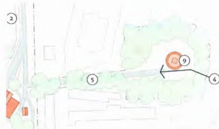
Zoom op de watertoren met opgang. De dichtgegroeide groene jas rondom de toren wordt deels vrijgemaakt van beplanting. De opgang blijft begroeid. Een eigen toegang vanaf de achterkant moet worden onderzocht.
